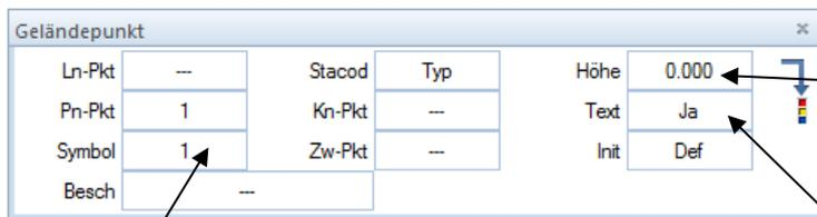
richtige Höhe eingeben, (0,000 OK Baugrube -3,0 m UK Baugrube)
