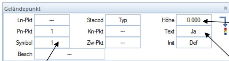
richtige Höhe eingeben, (0,000 OK Baugrube -3,0 m UK Baugrube)
